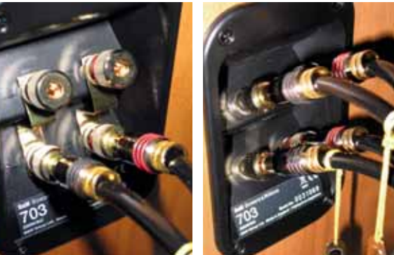
Von Haus aus ist B&Ws 703 mit Blechbrücken bestückt (l.). Beim Bi-Amping hängt jeder der beiden Eingänge an einem eigenen Verstärker (r.)
